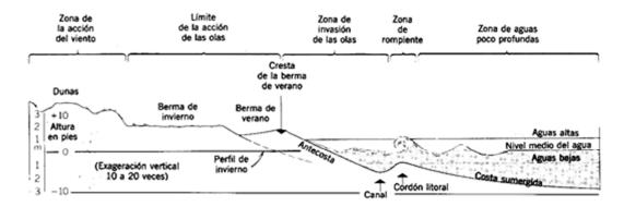
Figura 1. Modelo de playa y sus formas (Tomado de Strahler, A. 1997)
