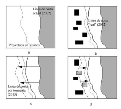
Figura 8. Tasa de erosion y su aplicacion a la planificacion (Tomado de Douglas, M. 1998)
