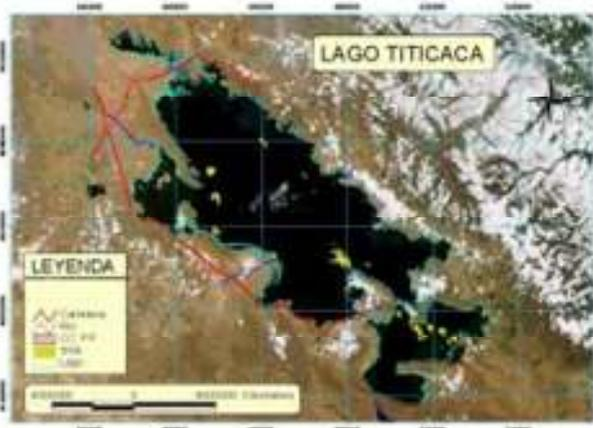
Se presentan imágenes de una composición de tres bandas: Banda 1 visible de 0,58 a 0,68  $\mu\text{m}$ , Banda 2 cercana al infrarrojo 0,725 a 1,10  $\mu\text{m}$  y Banda 3 infrarrojo de 10,30 a 11,30  $\mu\text{m}$ , obteniendo como producto una imagen a color, donde se puede apreciar los cuerpos de agua en la zona continental.
