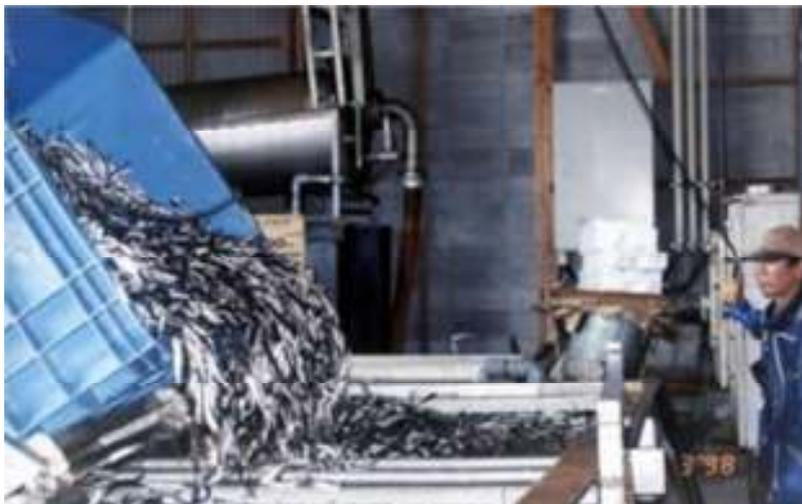
(b) Lavado y descamado: Actualmente las plantas de procesamiento de niboshi en el Japón depositan las materias primas en grandes contenedores con agua fría (capacidad de 3 a 5 m<sup>3</sup>) en donde es lavada y descamada simultáneamente. El proceso es ilustrado en el diagrama
