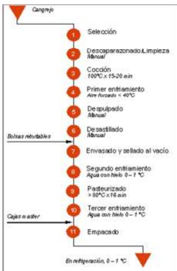
Gráfico 1: Diagrama de Flujo de Procesamiento de Pulpa de Cangrejo Pasteurizado en empaques flexibles
