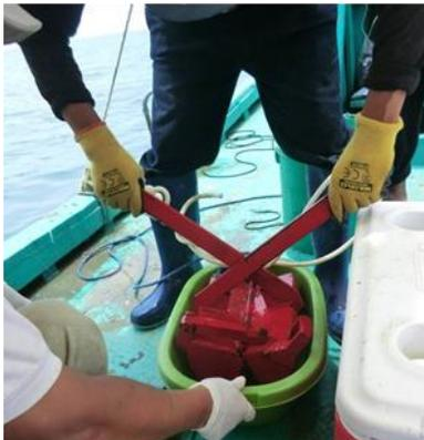
Muestreo de sedimentos superficiales a diferentes profundidades utilizando una Draga Van Veen
