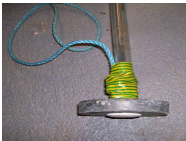
Fig. 3. Plomo con forma de disco que rodea el extremo inferior de la manguera de muestreo (Foto R. Raine).
