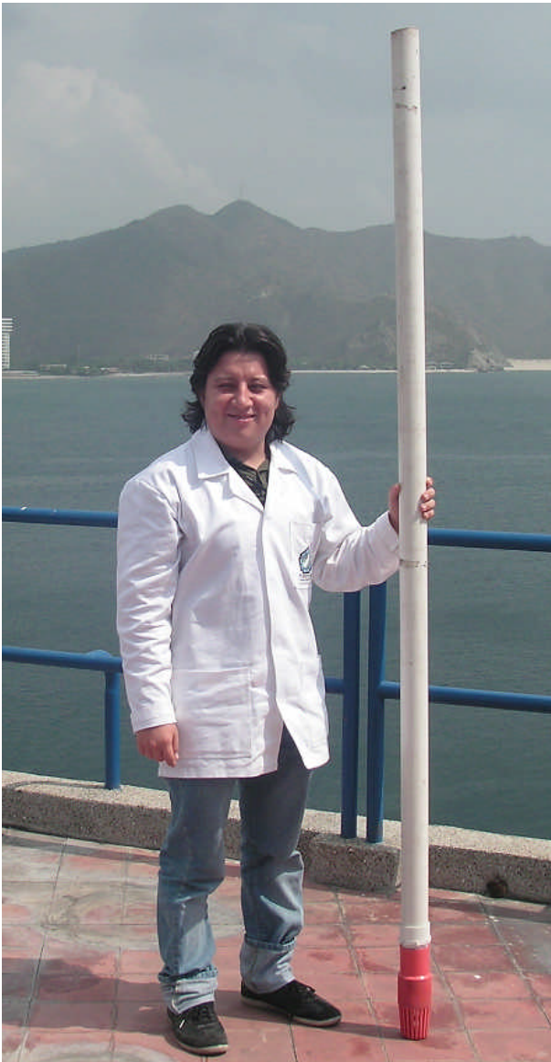
Fig. 5. Tubo muestreador (> 2 m), con válvula de retención del agua en el extremo inferior, utilizada por INVEMAR (Colombia).
