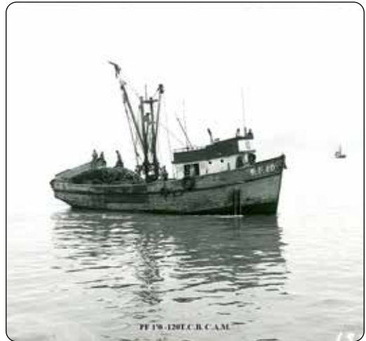
Embarcación pesquera PF 10 de madera, con 120 TCB (toneladas de capacidad de bodega).
