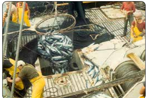
El pescado cayendo a las bodegas, que contienen agua de mar refrigerada.
