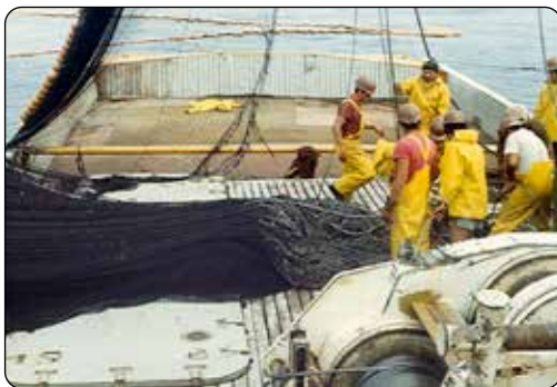
Cierre de bolsa para jaretear o levantar la red.
